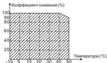
Рисунок 3-2. Снижение номинальной мощности преобразователя частоты GD20 в зависимости от температуры окружающей среды.
