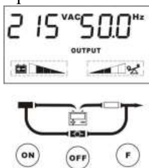
Рисунок 8.4 - Режим работы в обход ИБП
